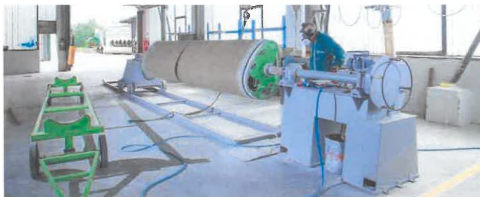
Нарязване и шлифване на тръбите по размер
