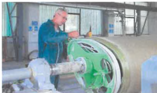
Създаване на краищата за свързване на тръбата
