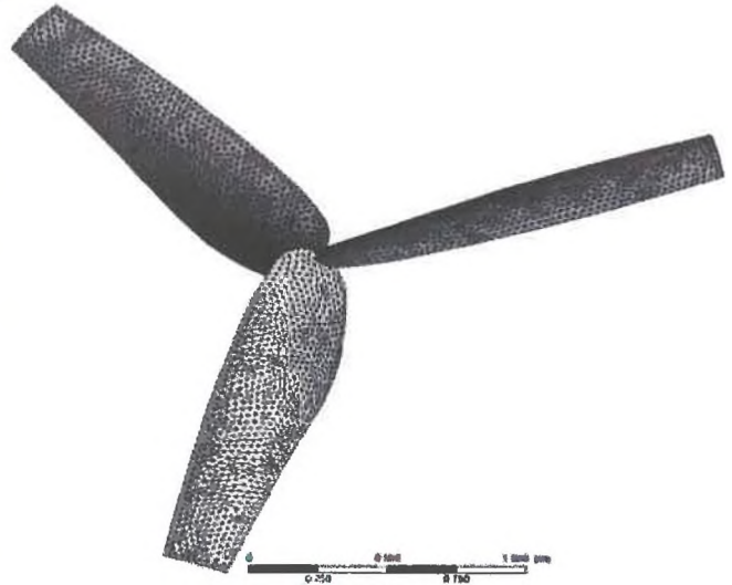
Фигура 4 – Структура на мрежата в резервоара (поглед отгоре) Фигура 5– Гъстота на мрежата по повърхността на острието
